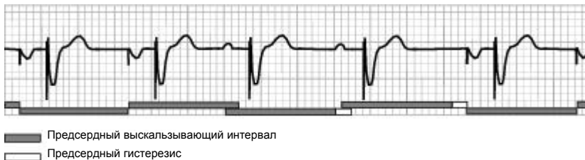
Рис. 9-8. Предсердный гистерезис в режиме DDD(R)
