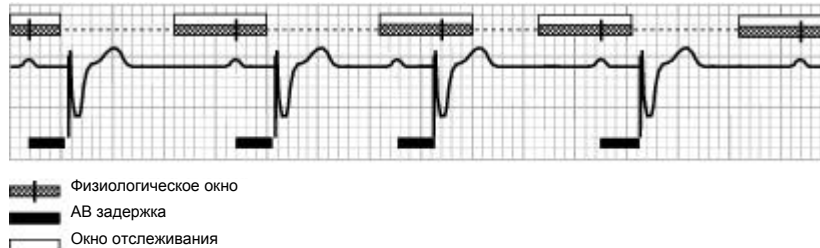
Рис. 10-10. Реакция на предсердную тахикардию, если переключение режима установлено на «Умерен.».
