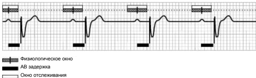
Рис. 10-3. Предсердное отслеживание в ответ на синусный ритм
