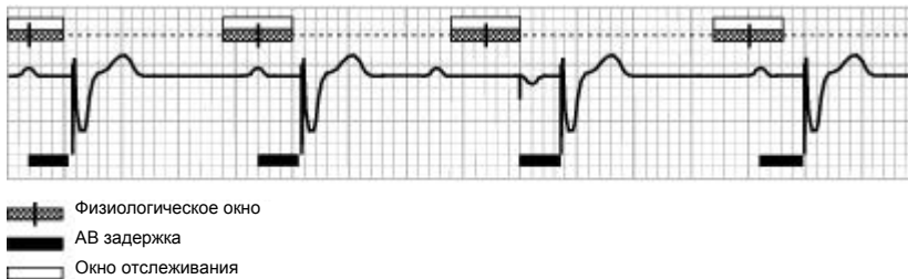
Рис. 10-10. Реакция на предсердную тахикардию, если переключение режима установлено на «Умерен.».
